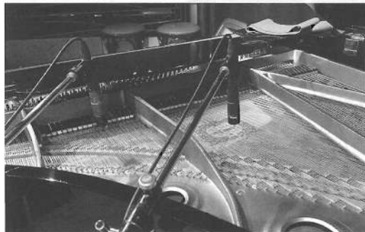
ピアノはSM57×2、Roland M-200i Live Mixing Consoleに、メインはMeyer sound UPA-1B、転がしはElectro-Voice。ほとんど生音でもっともシンプルなセッティング
